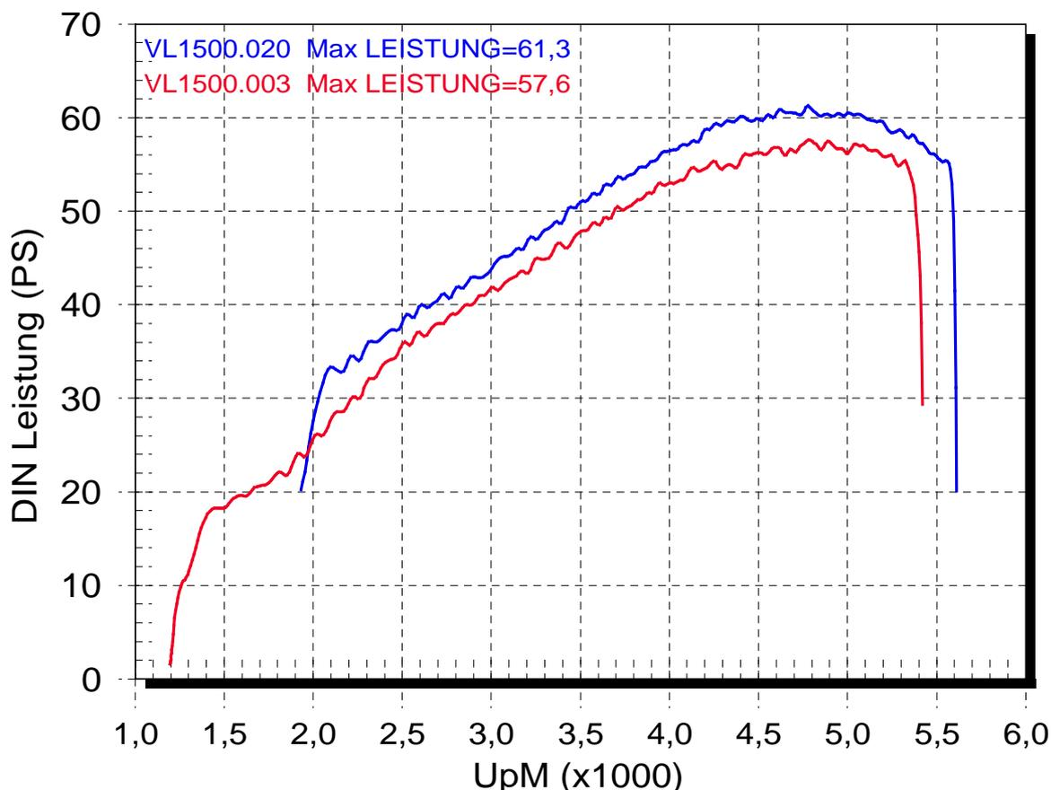
**Originalleistungsdiagramm einer VL 1500 mit Dyna 3000 elektronischer Zündanlage**
