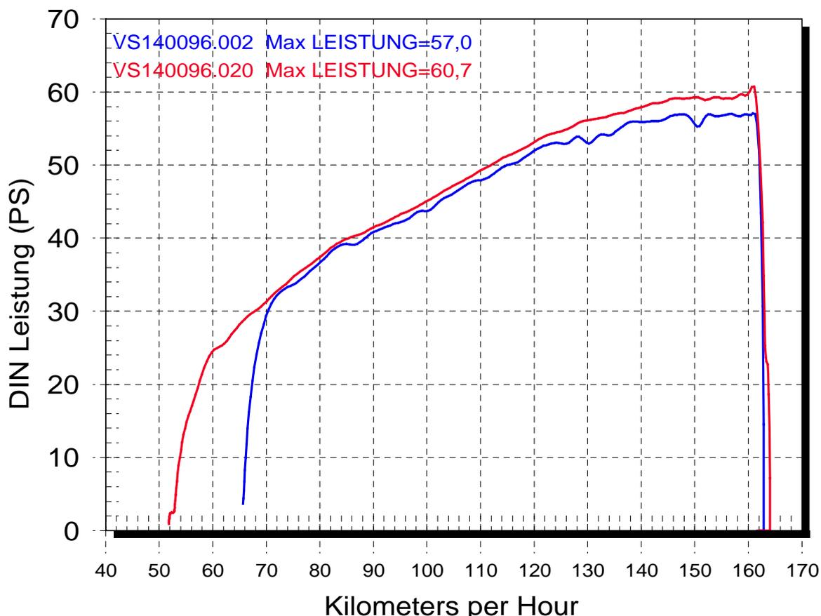
**Originalleistungsdiagramm einer VS 1400 mit Dyna 3000 elektronischer Zündanlage
