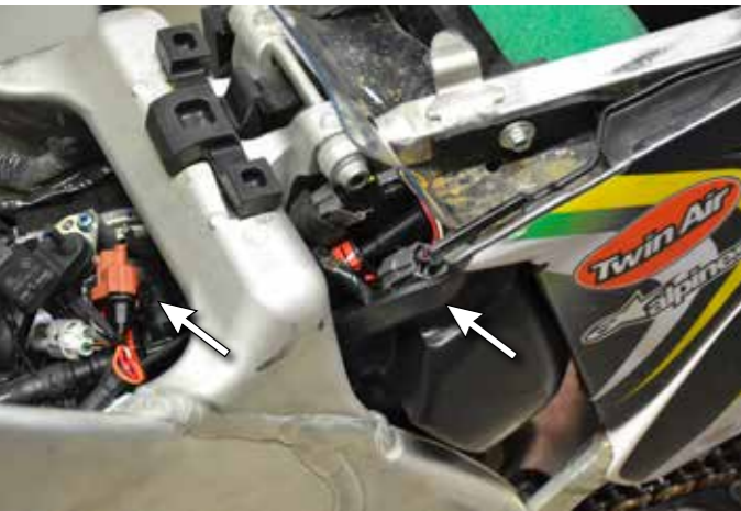
Besonderheit: Die Kawasaki verfügt über zwei Einspritzdüsen. Die erste im Ansaugtrakt – grauer Stecker – und die zweite im Drosselklappenkörper – orangefarbener Stecker
