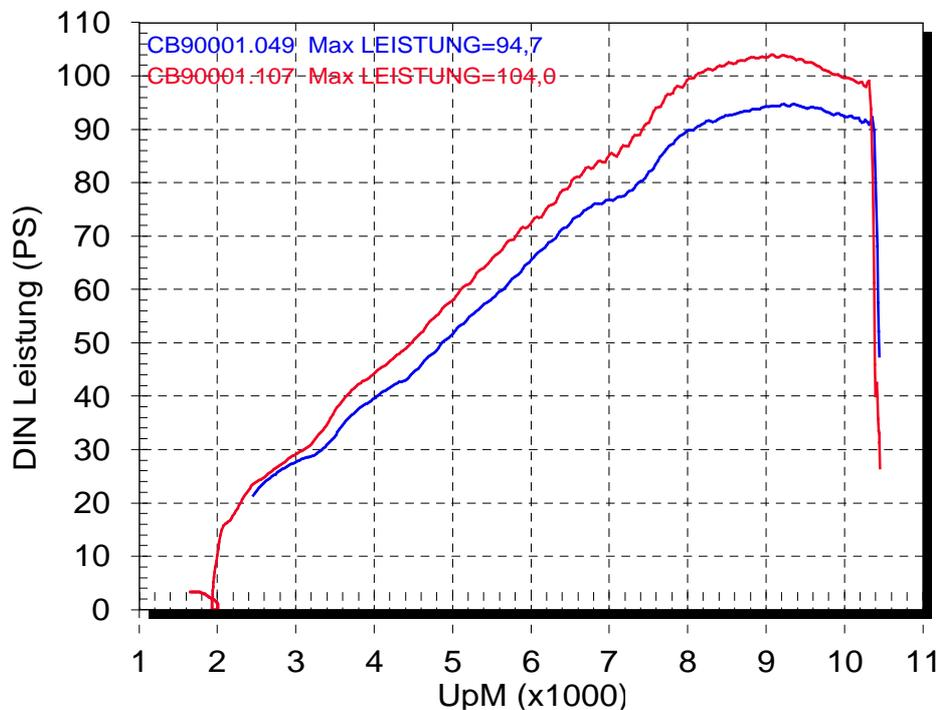
***Originalleistungsdiagramm einer Hornet 900 mit Zubehörauspuffanlage mit EG, Powercommander Illusb und Luftfiltermodifikation***
