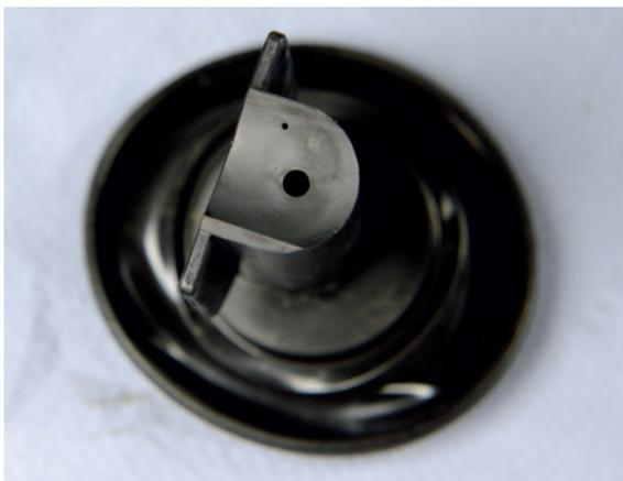
Es half nichts, auch grobes Gerät kam bei der Optimierung zum Einsatz: Die Ausgleichsbohrung fürs Vakuum im Vergaserschieber musste aufgebohrt werden
