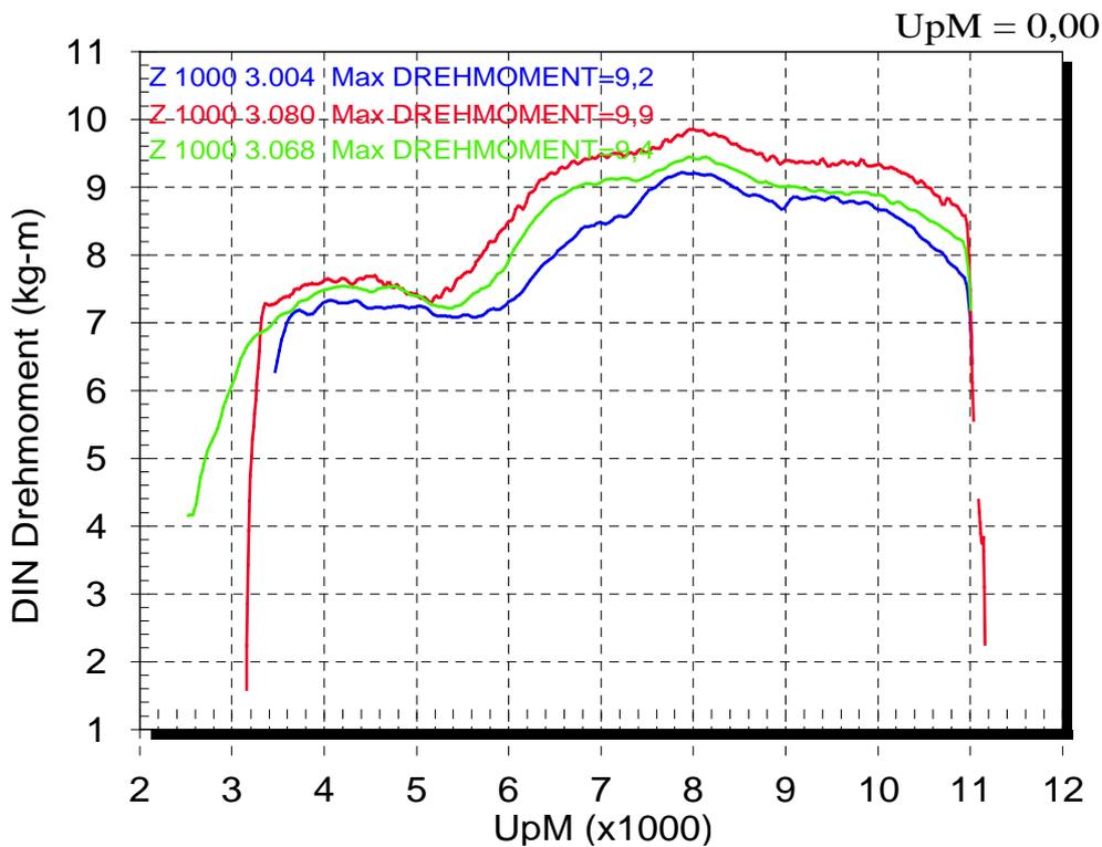
**Originaldrehmomentdiagramm einer Z 1000 2003 mit Micron Racing-Auspuffanlage (grüne Kurve), Powercommander Illusb und Luftfiltermodifikation**
