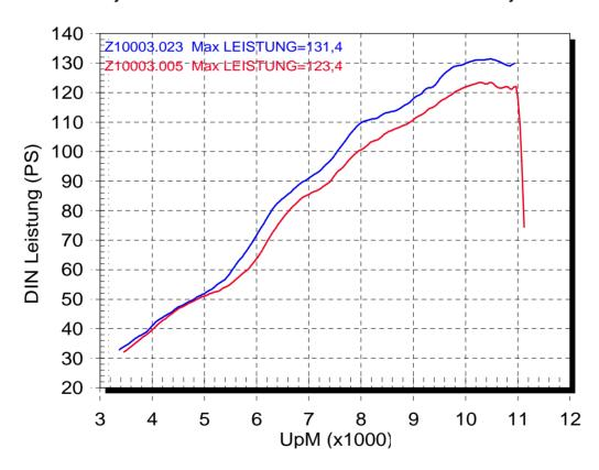
Originalleistungsdiagramm einer Z 1000 2003 mit Leo Vince Endtöpfen mit Betriebserlaubnis und
