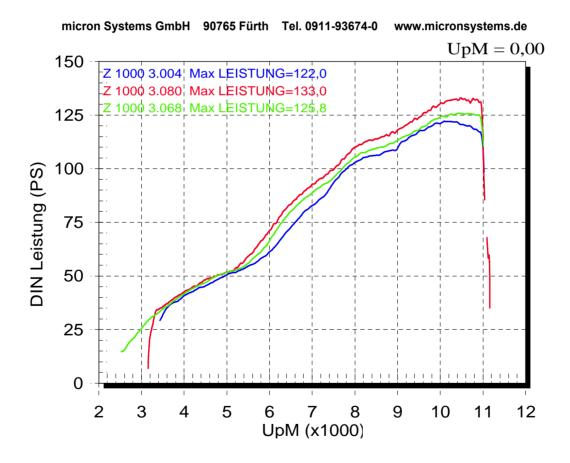
Originalleistungsdiagramm einer Z 1000 2003 mit Micron Racing-Auspuffanlage (grüne Kurve), Powercommander Illusb und Luftfiltermodifikation
