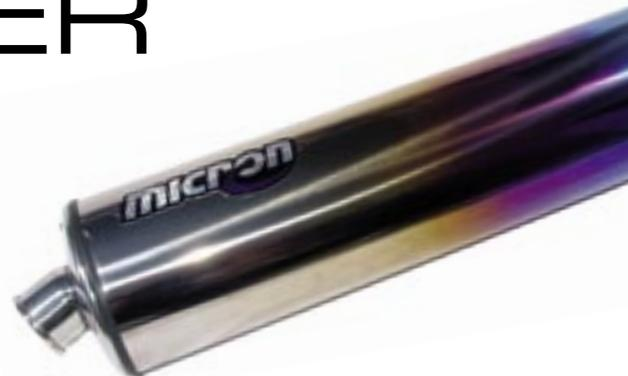
Daher wurde die 4-in-1 Zeta-Krümmernanlage zusammen mit dem EG zugelassenen Endtopf und leicht entfernbarem dB-Killer-einsatz von micron Systems angebaud. Die leichte Anlage mit Edelstahl-Rohren und dem superleichten Titan-Endtopf reduziert das Gewicht um mehr als 11 Kilo im Vergleich zur Originalanlage auf nun knapp sechs Kilo. Dadurch wird ganz nebenbei das ohnehin schon sehr gute Handling der Kawa weiter verbessert.
