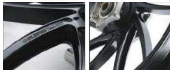
徹底した強度解析を行い、応力の分散に優れた形状で設計。加速と制動、どちらの荷重も受け止める10本のラウンドスポーク。
