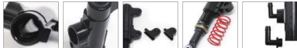
φ12ピストン      A6061材アルミボディ      様々な取付けピッチに対応      2種類のリターンスプリング 黒(スタンダード)/赤(ハード)      90度ニップル(φ7.3/φ6) φ7.3: NISSIN対応 φ6: GALESPPEED, brebmo対応
