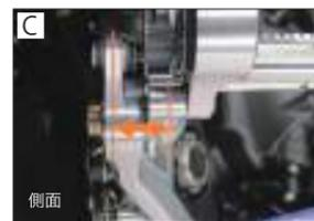
ペダルピボットとマスターッシュロッドとのオフセットを最低限に抑え、操作時のたわみを軽減。
