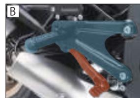
転倒時のトラブルを回避するため、ブレーキ・チェンジペダルとステップバーが別軸になるよう設計。
