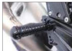
ステップバーはCNC切削加工を駆使し、コーナリング中でもブーツが滑りにくい溝形状を採用。
